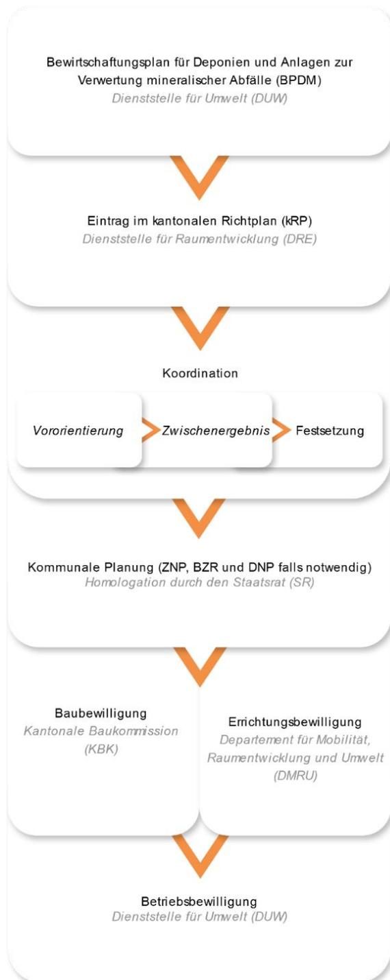
Abbildung 2: Erklärendes Schema der Verfahrensschritte für das Erlangen der Betriebsbewilligung einer Deponie
