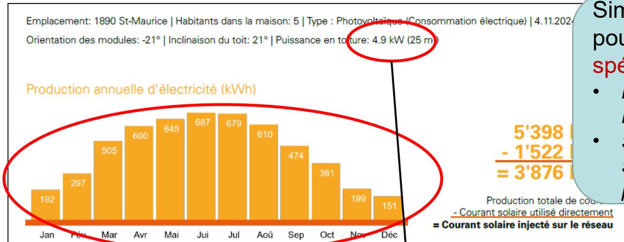
Simulation sur calculateur pour identifier l'énergie spécifique produite sur le site
