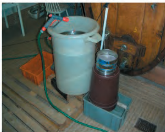
Fig. 3. Die Bodenproben wurden mit einer Flotationsmaschine (Maschenweite 0,4 - 5 mm) vorbereitet.
