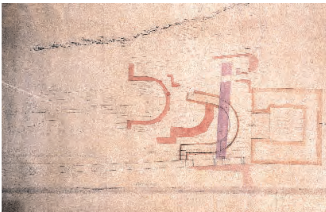
Fig. 35 Secteur des absides orientales et du clocher, relevé dressé lors des fouilles du chanoine Bourban. Le couloir de la crypte avec l'escalier d'accès sont clairement délimités au sud comme au nord. Le mur rectiligne mauve perce le couloir et remplace l'arrondi de la paroi interne.
