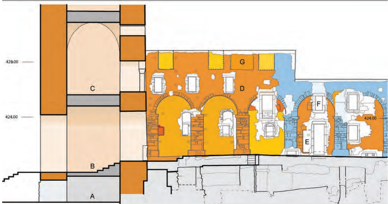
Fig. 9/7A. Martolet. Élévation sud du vaisseau central, relevé archéologique. Les arcs des carolingiens (bleu clair) et romanes (orange) sont percés par les ouvertures de la façade baroque (blanc). A) Soubassement de l'église et du baptistère antérieurs ; B) Soubassement restitué du porche roman (rez-de-bas au-dessus du clocher) ; C) Chapelle Saint-Michel ; D) Élévation du vaisseau central ; E/F) porte surmontée d'une fenêtre ; G) ouverture remplaçant les trois fenêtres étroites
