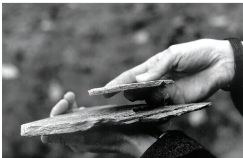
Fig. 16 : Les plans de schistosité successifs des dallettes permettent de détacher des plaquettes peu épaisses (photo : Ch. Croutsch).
