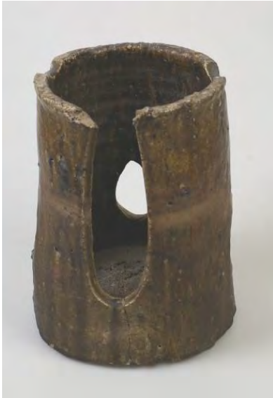
Fig. 29 : Exemples de gazettes utilisées par le porcelainier anglais Wedgwood avant 1760 © Wedgwood Museum.
