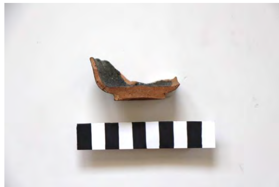
Fig. 5 : Exemples de pièce rejetée en raison d'un important défaut de la glaçure.
