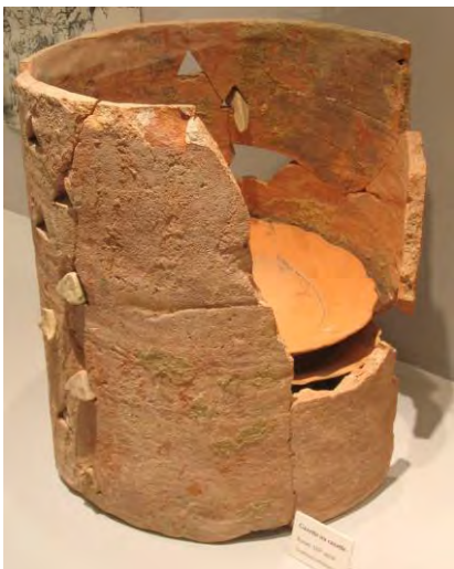
Fig. 2 : Exemple de cazette utilisée pour la poterie au 19 e siècle exposée au musée de la céramique de Rouen. 18
