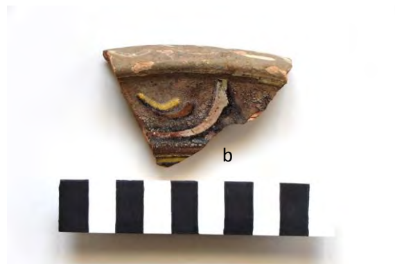
Fig. 6 : Ces pièces ont été rejetées en raison a) d'un encroûtement d'argile et b) d'un défaut de la glaçure qui présente un aspect bulleux et craquelé.
