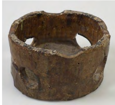
Fig. 29 : Exemples de gazettes utilisées par le porcelainier anglais Wedgwood avant 1760 © Wedgwood Museum.
