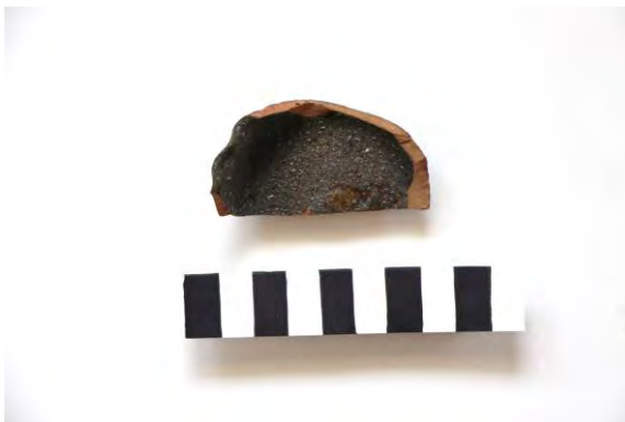
Fig. 5 : Exemples de pièce rejetée en raison d'un important défaut de la glaçure.
