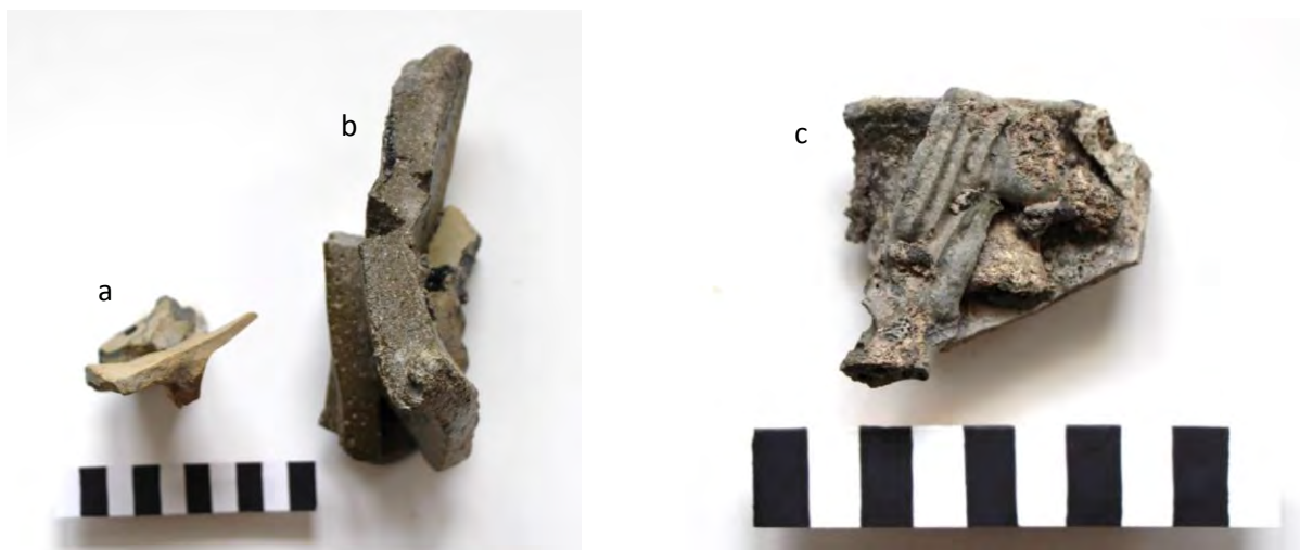
Fig. 24 : Accidents de cuisson au cours desquels les supports et les objets produits se sont collés et ont progressivement vitrifié sous l'effet de la chaleur a) couvercle encastré, b) catelle, c) tasse.
