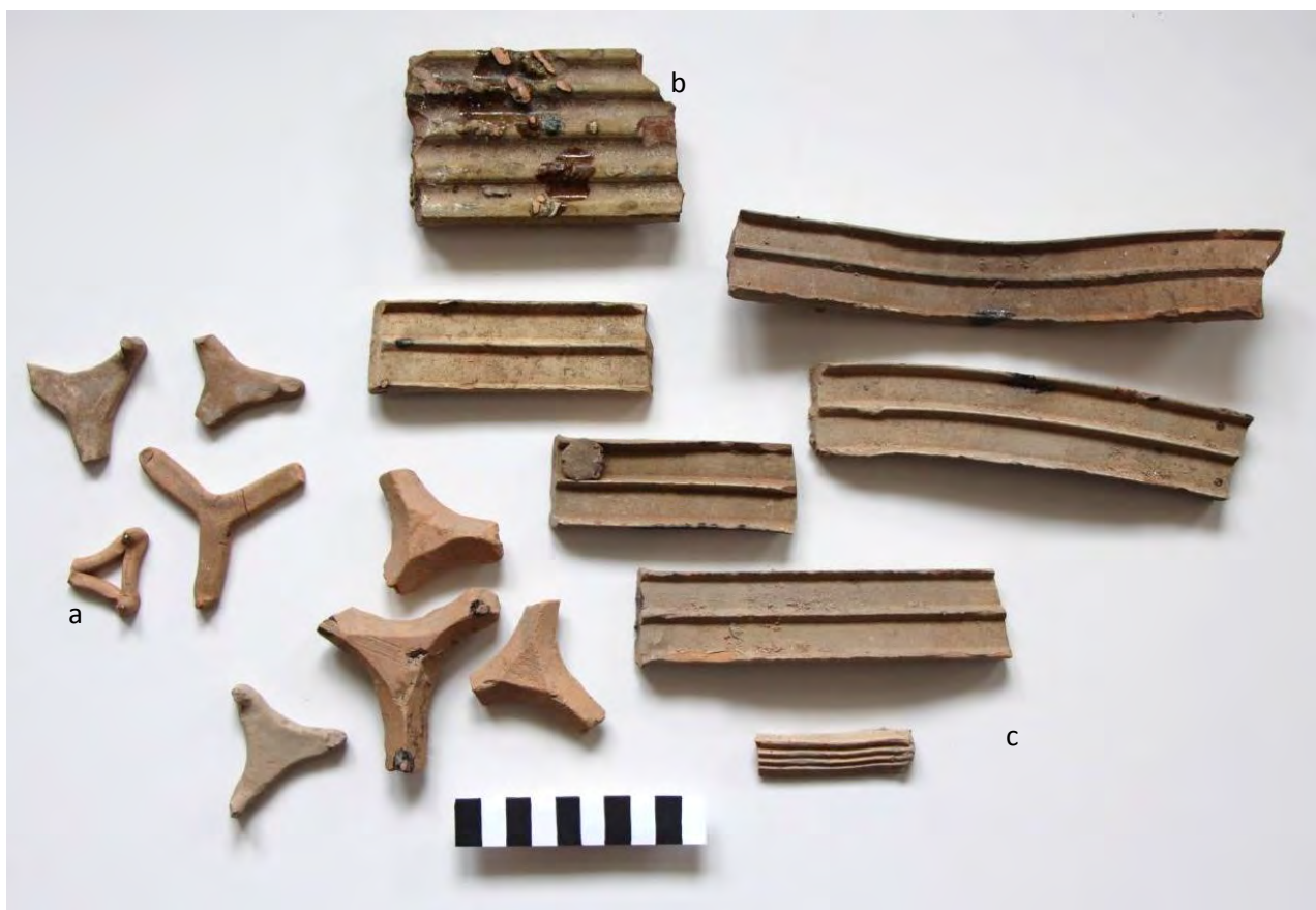
Fig. 25 : Exemples de pernette : a) tripodes, b) rectangulaires, c) triangulaires.
