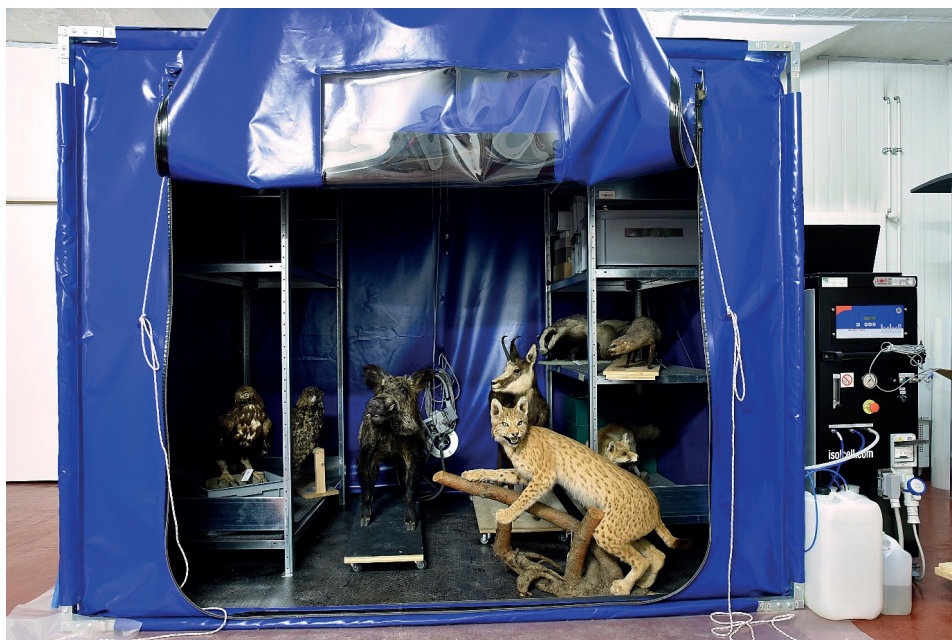
Fig. 5. Chambre d'anoxie Isolcell.
