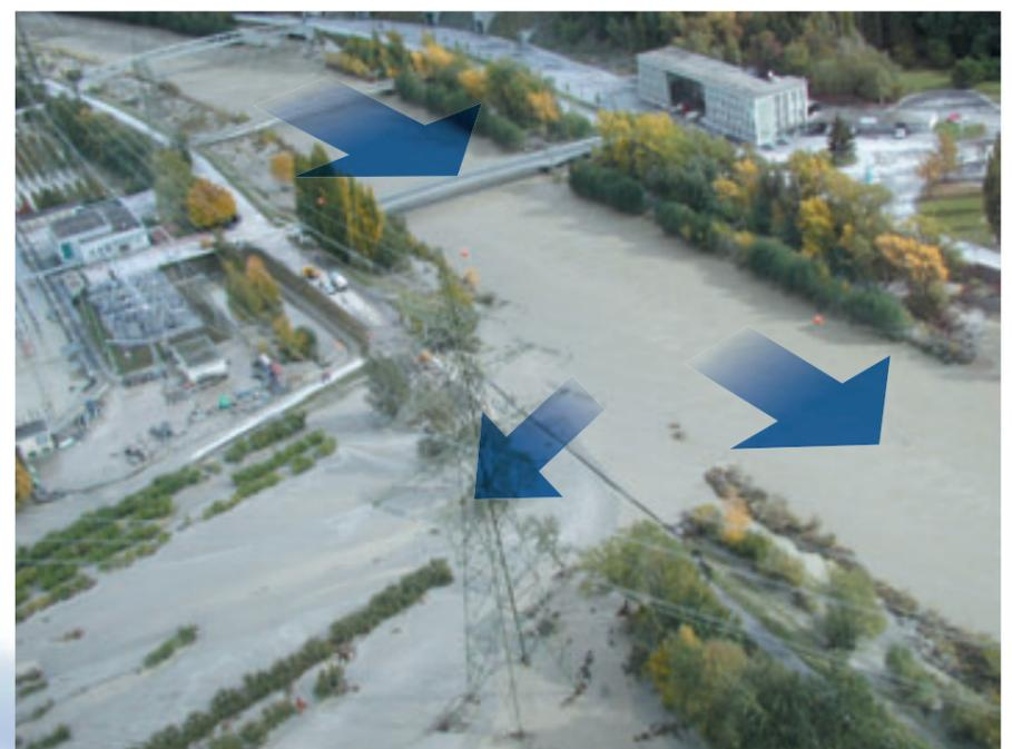
En cas de rupture de digue du Rhône, comme ici à Chamoson, ce sont plus de 200 m<sup>3</sup>/s d'eau chargée de limons (l'équivalent de la Dranse en crue) qui déferlent dans la plaine du haut des digues de 4 mètres.
